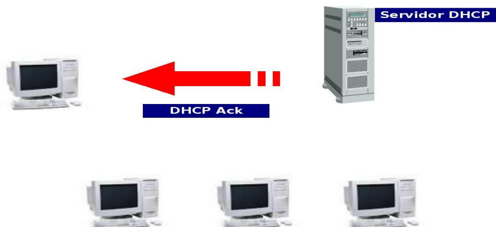
Ilustração 11: DHCP Ack. Confirmação do lease do endereço pelo Servidor
