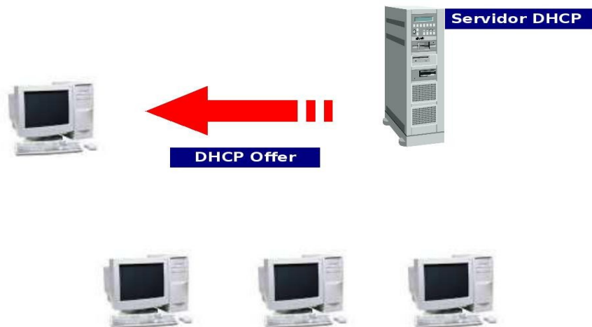
Ilustração 9: DHCP Offer. Resposta do Servidor DHCP à estação
