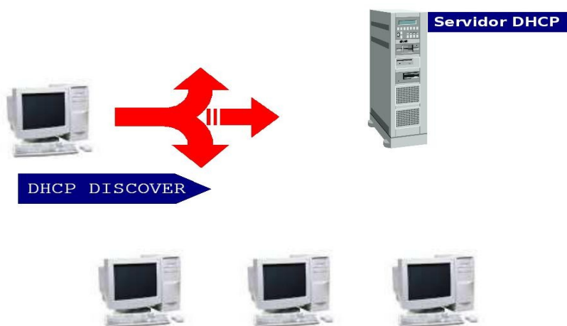
Ilustração 8: DHCP Discover. Pacote enviado pela estação
